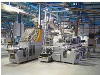
Дальше – варят, чтобы получить волокнистую массу, похожую на жидкое тесто. Машины разливают и раскатывают бумажное тесто, потом из полос получается бумага. Бесконечной лентой выползает бумага из машины и сматывается в огромные бумажные рулоны.
